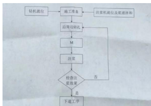
图 4-2 周边小导管注浆工艺流程图
